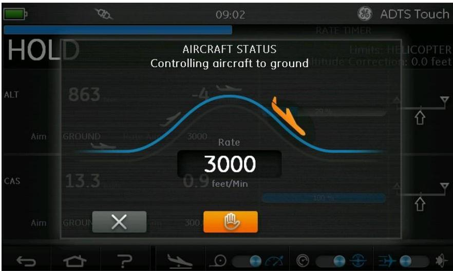
그림 3-16 지상으로 이동하기 위한 경사로 이동 중의 HOLD 상태
